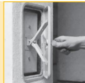
32. Удалите транспортный фиксатор с рычага дверцы и, закрывая наружную дверцу, прижмите внутреннюю часть дверцы.
