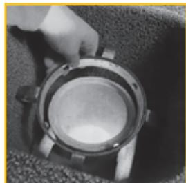
13. Установите распорное кольцо на внутреннюю керамическую трубу. Два последующих соединения труб закрепляются манжетой для обеспечения дополнительной прочности и газоплотности, затем вновь устанавливается распорное кольцо и т.д.
